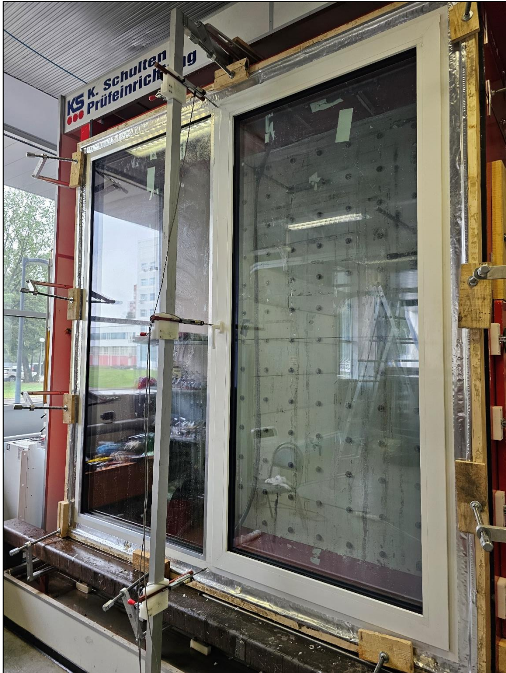
Рисунок 4.1 – Образец 976-23/2 в процессе испытания на сопротивление ветровой нагрузке
