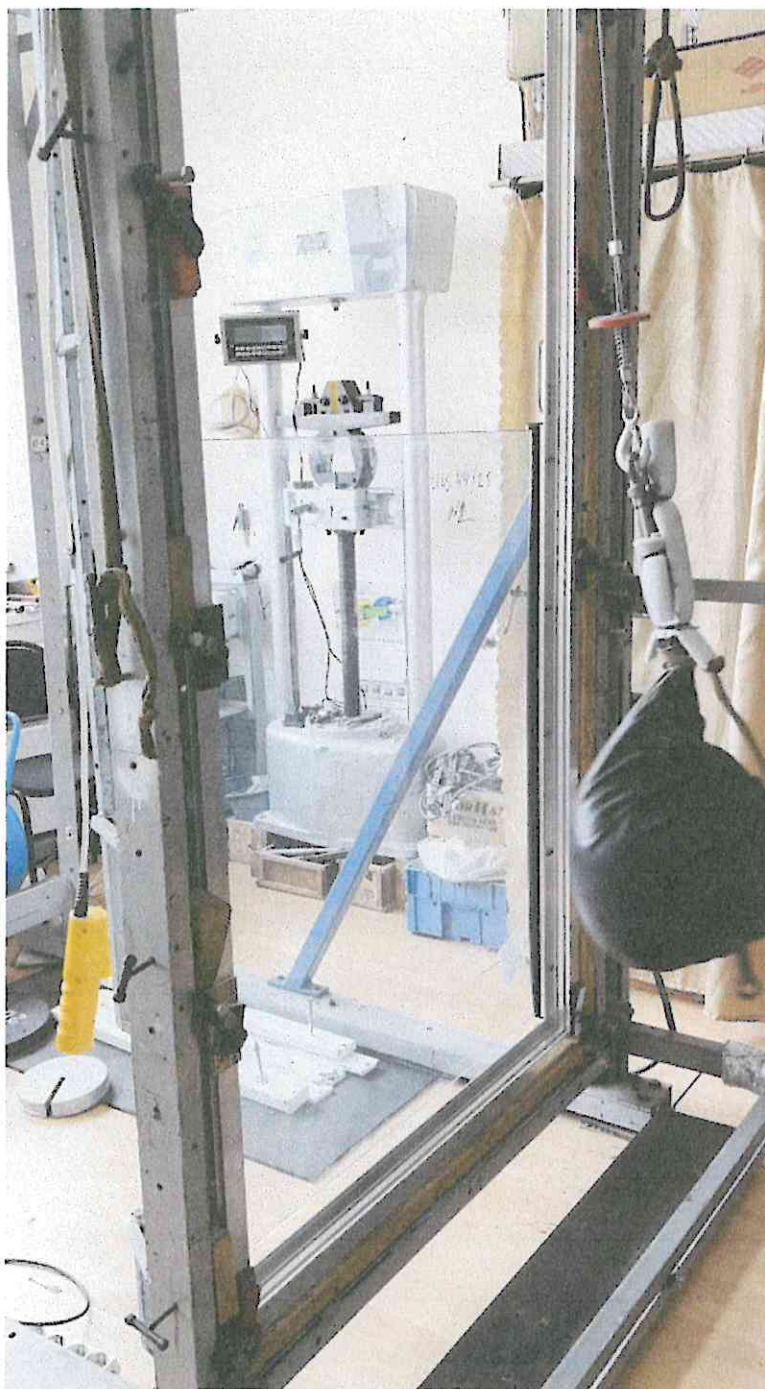
Образец защитного экрана из алюминиевых профилей серии Alumark S40 BF-S без поручня, после удара мягким телом (мешком с песком массой 30,0 кг), конструкция экрана без признаков нарушения целостности.
