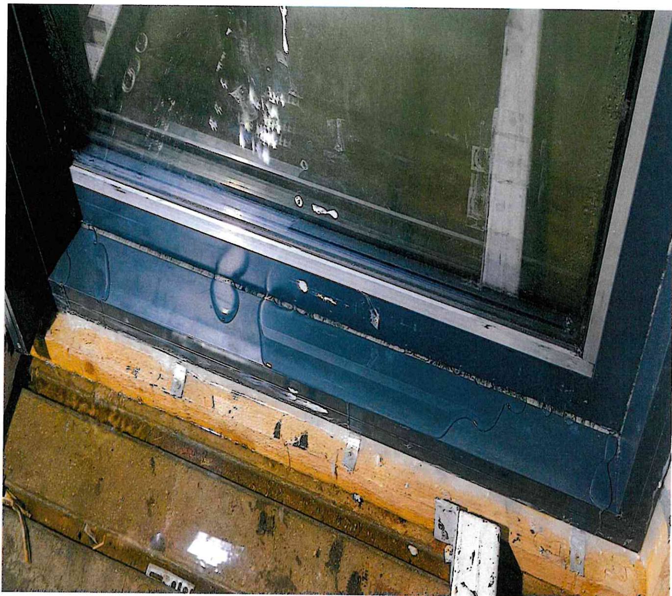
Рис. 10 Место протекания конструкции при \Delta P=600 Pa.
