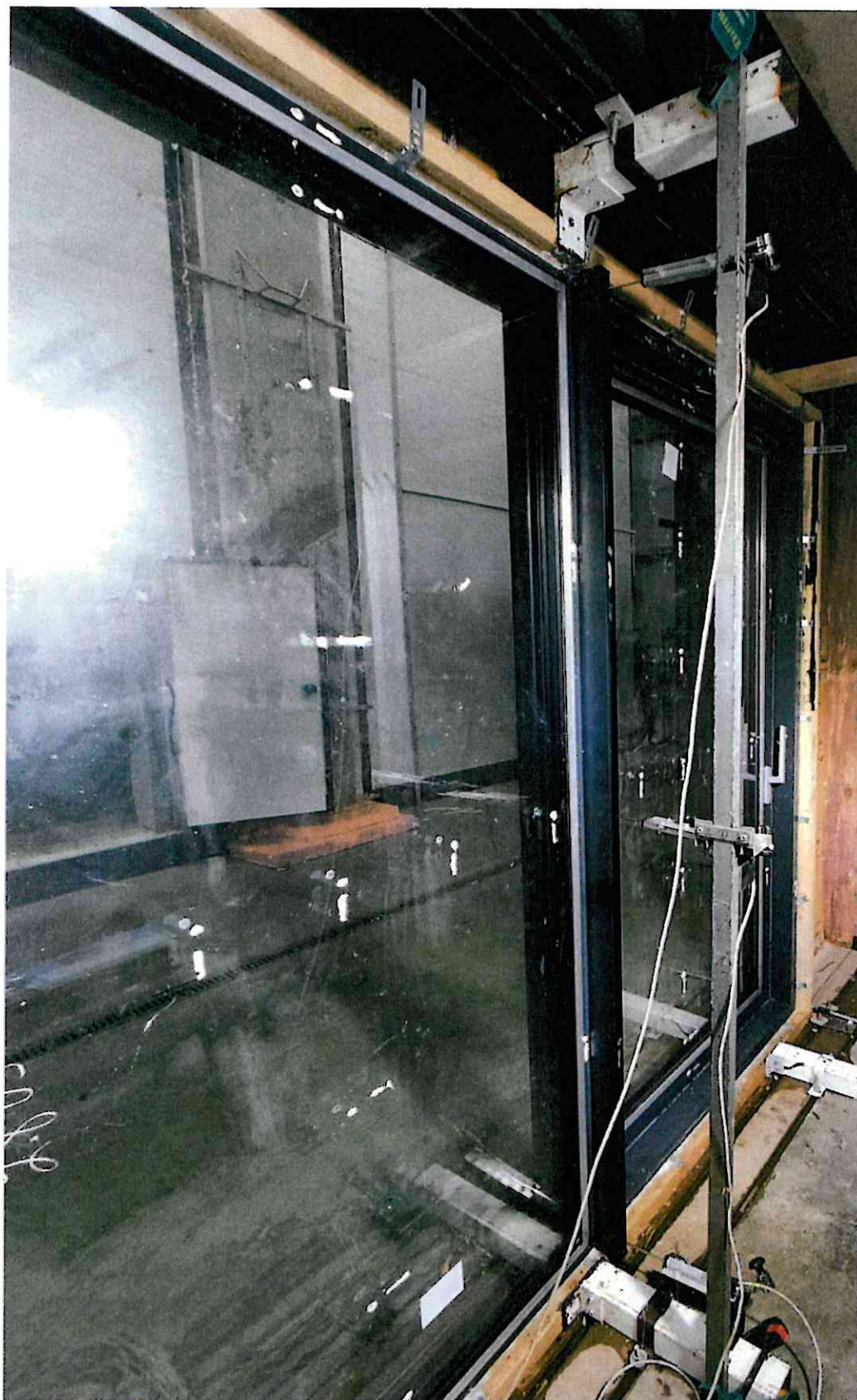
Рис. 6 Внешний вид блока дверного при проведении испытания на сопротивление ветровой нагрузке, точки М1-М3.
