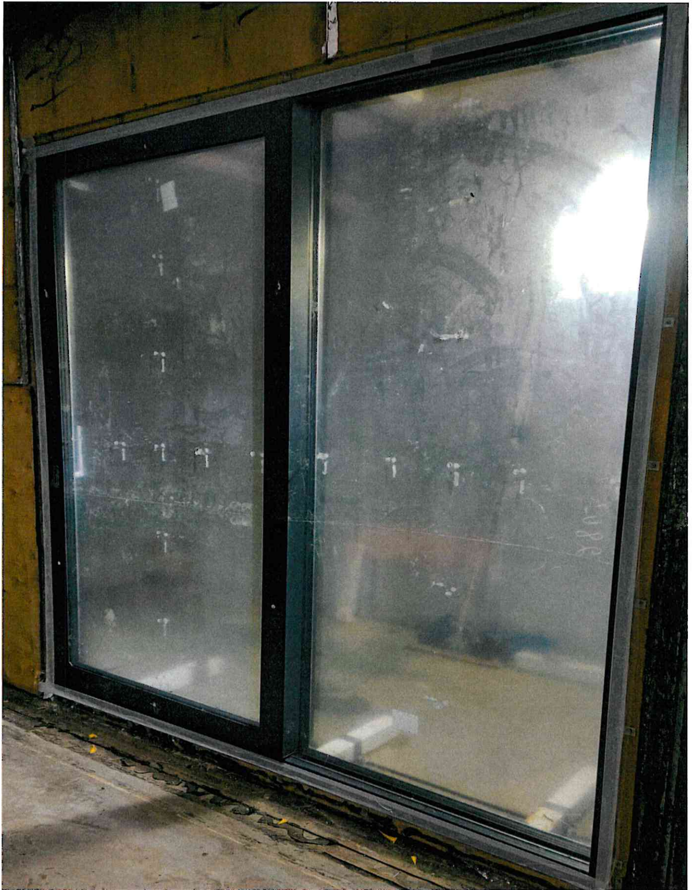
Рис.4 Внешний вид блока дверного при проведении испытания на воздухопроницаемость
