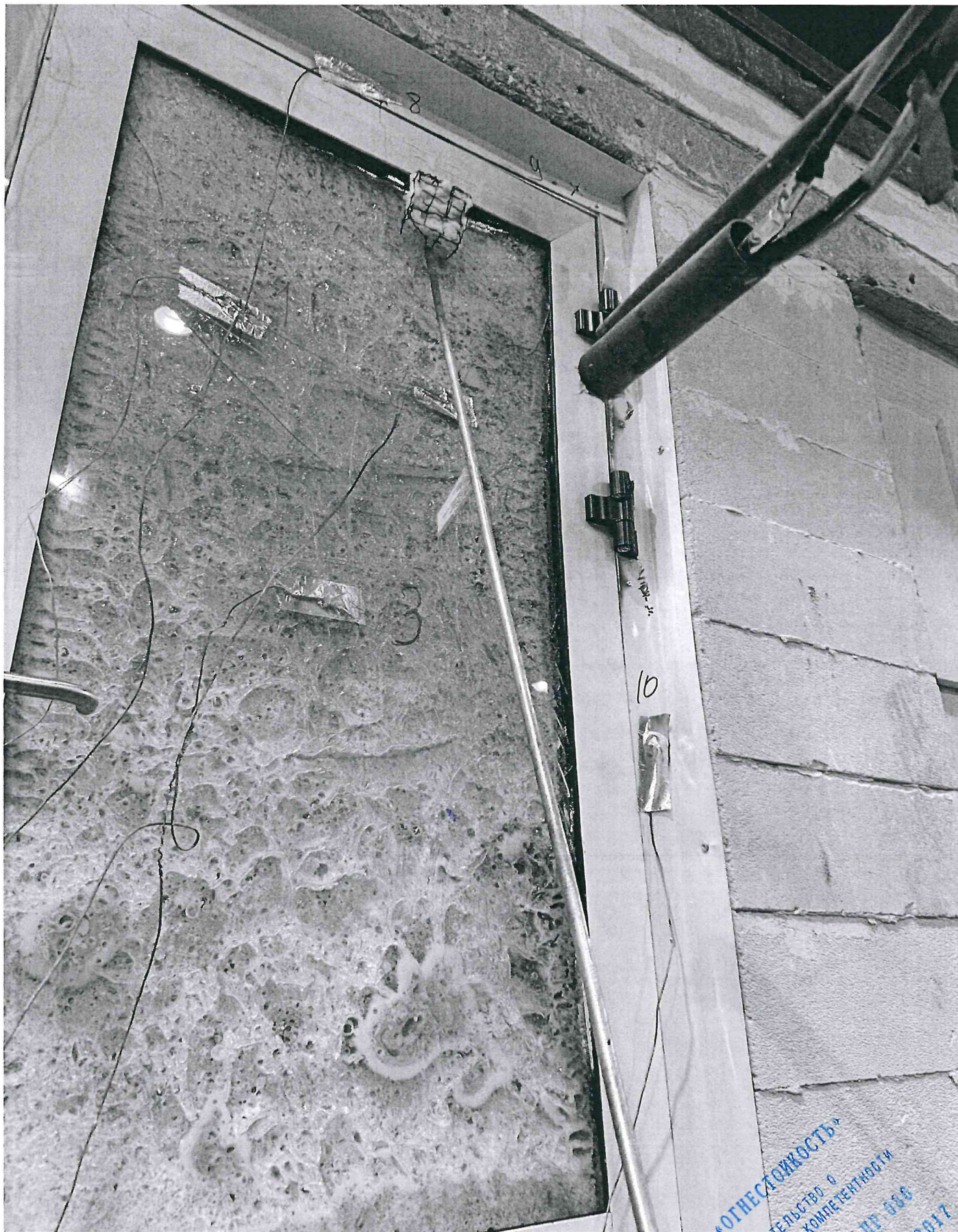
Фото 7. Образец № 1 в процессе испытания (определение потери целостности (Е) при помощи контрольного ватного тампона (КВТ). КВТ не воспламенился.
